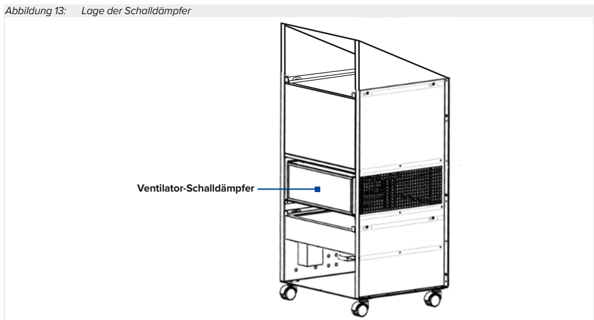
Abbildung 13: Lage der Schalldämpfer
