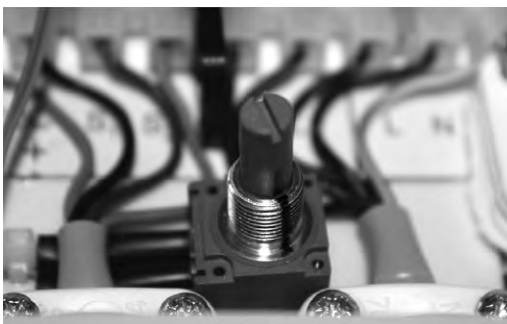
Markieren sie die eingestellte Position am Potentiometer, so können Sie die optimale Einstellung immer wieder schnell herstellen.
