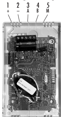
Elektronikplatte des CO 2 -Fühlers (Modell kann variieren)
