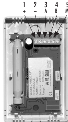
Elektronikplatte des CO 2 -Fühlers (Modell kann variieren)
