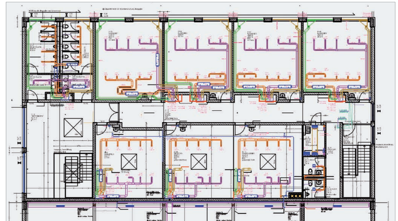
1 Lüftungsgerät • 2 Schalldämpfer • 3 Rohrsystem • 4 Zuluftventil • 5 Abluftventil
