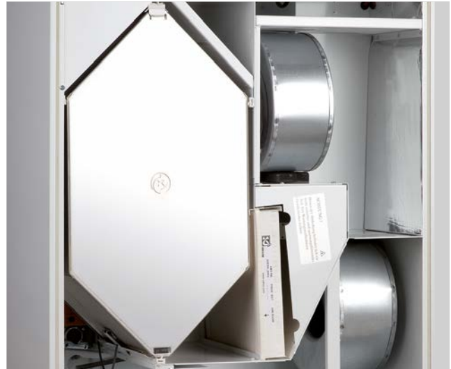
Der integrierte Kreuz-Gegenstrom-Wärmetauscher erzielt einen Wärmerückgewinnungsgrad von bis zu 90%, so dass der größte Teil der Heizwärme wieder über die einströmende Zuluft an den Raum zurückgeführt wird.
